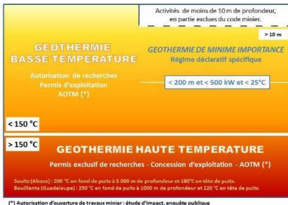
**Figure 40.** La géothermie Haute température, la géothermie basse température et la géothermie de minime importance
